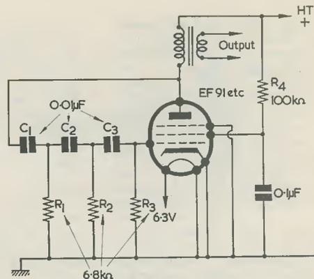
Fig. 11. A phase shift oscillator
