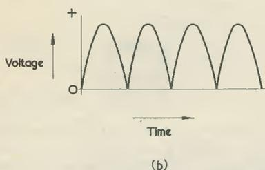
Fig. 256 (a). The bridge rectifier
